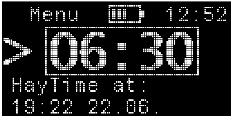
Näyttökuva: Mode 1 näyttötila, kun vapautus on asetettu 6h ja 30min päähän
