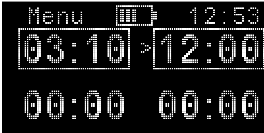
Näyttökuvaa: Mode 2 näyttötila, kun vapautukset on asetettu kello 3.10 ja 12.00
