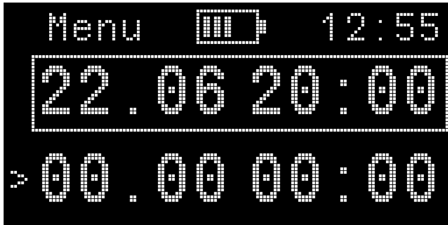
Näyttökuvaa: Mode 3 näyttötila, kun vapautus on asetettu aukeamaan 22.6. kello 20.00
