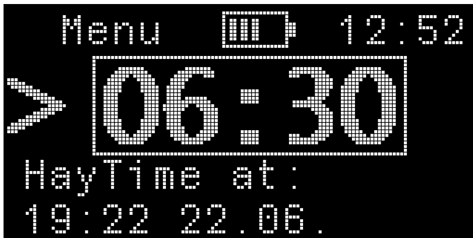
Bildschirm: Modus 1 Ansicht, wenn die Auslösung auf 6h und 30min eingestellt ist
