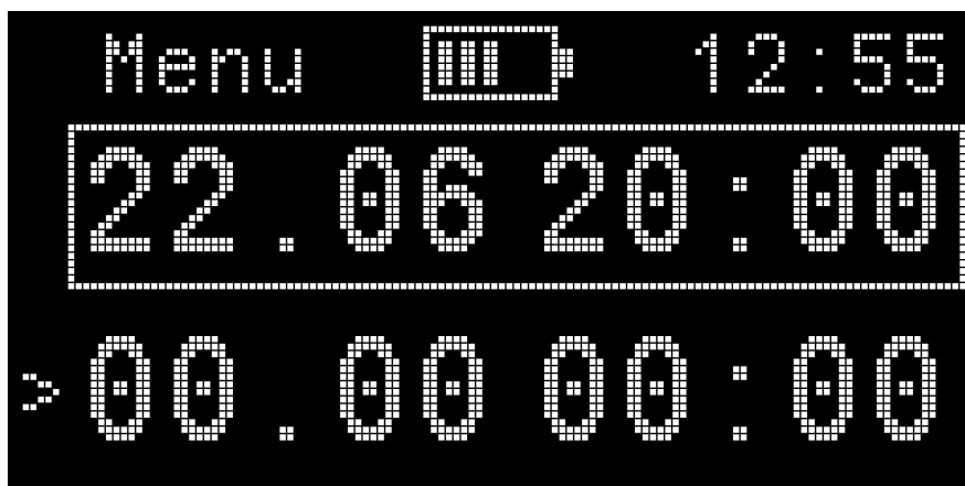
Bildschirm: Modus 3 Ansicht, wenn die Auslösung auf den 22.6. um 20:00 Uhr eingestellt ist
