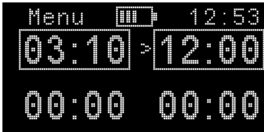
Bildschirm: Modus 2 Ansicht, wenn die Auslösungen auf 3:10 und 12:00 Uhr eingestellt sind
